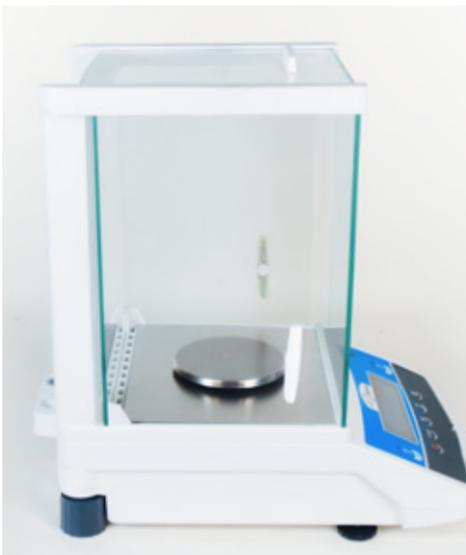
Balanza analítica de alta precisión (0,1 mg) rápida y precisa para su uso en laboratorio e industria. Rápidos resultados (menos de 3 segundos). Cabina corta aires de gran resistencia y funcionalidad que asegura la protección a efectos externos para una mayor precisión.
